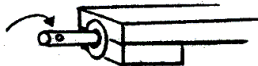
PERFORACIÓN EN EL EJE PARA PASAR LA CHAVETA
